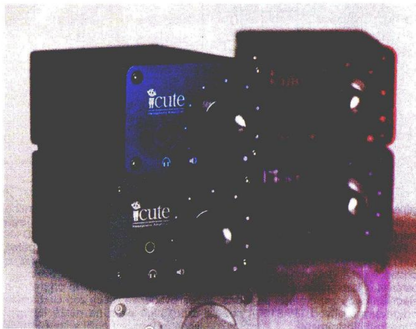
Ukázka profesionálního sluchátkového zesilovače vestavěného do hliníkového trubkového profilu
