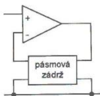
Obr. 55. Nízkofrekvenční selektivní zesilovač – základní zapojení
